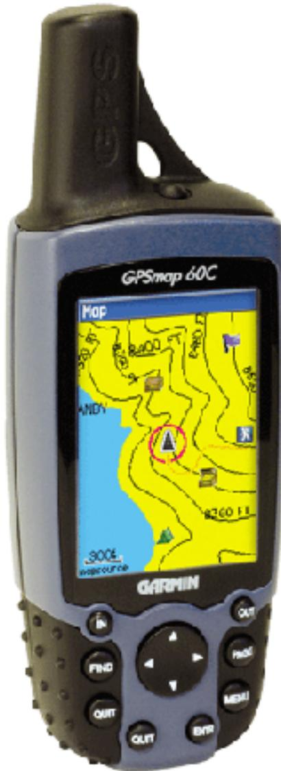
Il sistema GPS permette di posizionare un punto sulla superficie terrestre con precisione variabile dal mm a pochi metri (x,y,z). E' in sostanza costituito da uno strumento che riceve mediante un'antenna i segnali di satelliti in orbita geostazionaria.
